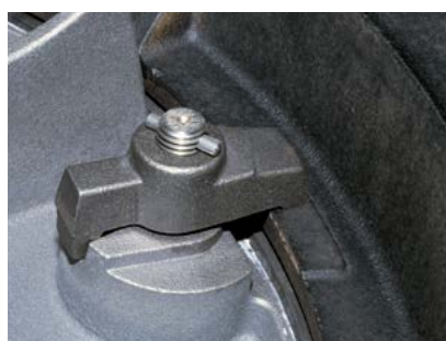
uzamykání pomocí speciálního otočného uzávěru
