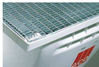
Rošt s oky 30 x 10 mm : pochozí, zatížitelné do 1,5 kN. pojezdny, zatížitelné do 9,0 kN.
