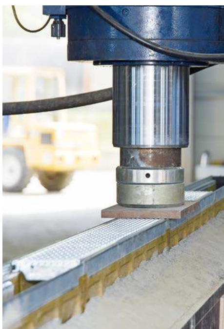
Testování vodotěsnosti při dlouhodobé simulaci
