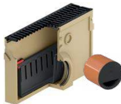
Odtoková vpust včetně kalového koše (PP) s odtokem DN/OD 110 (možno doplnit o pachový uzávěr obj. č. 01684)
