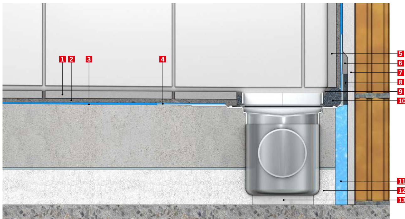
Příčný řez, vzorová ukázka instalace s protihlukovou ochrannou
