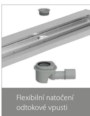
► V závislosti na stavební situaci můžete žlab ACO ShowerDrain M+ kombinovat se čtyřmi různými odtokovými vpustmi. Tyto vpusti lze flexibilně upravit pro připojení odtokového potrubí DN40 nebo DN50 a otočit až o 360° do požadovaného úhlu pro přímé napojení na kanalizaci. Vpust je se žlabem po instalaci pevně sešroubována, čímž je docíleno bezpečné těsností.
