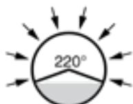
LP částečně perforované drenážní trubky
