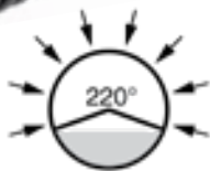
LP částečně perforované drenážní trubky
