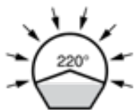
LP částečně perforované drenážní trubky
